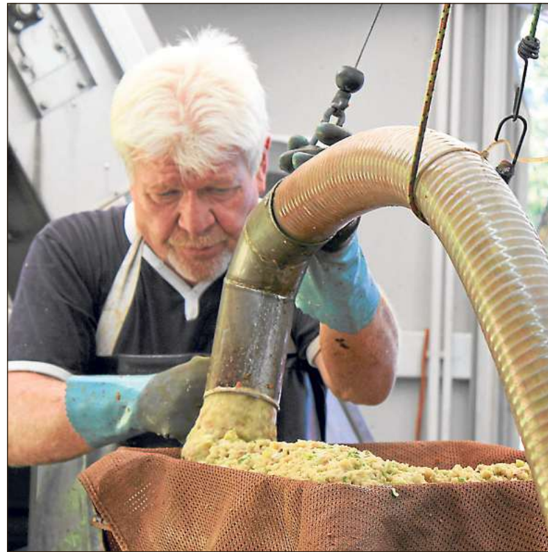
Mit einem Schlauchsystem füllt Richard Heinze die zerkleinerte Apfelmasse in Netze. Bilder: Junker
